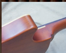
体にやさしくフィットするボディバ ックの面取り加工。
